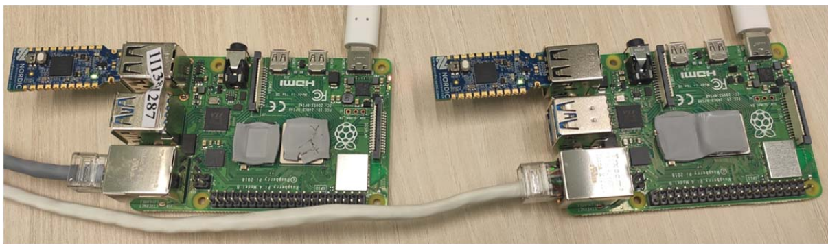
Рисунок 2. Розроблені макетні зразки системи захищеного інформаційного обміну текстовими даними через радіоканал ISM-діапазону
